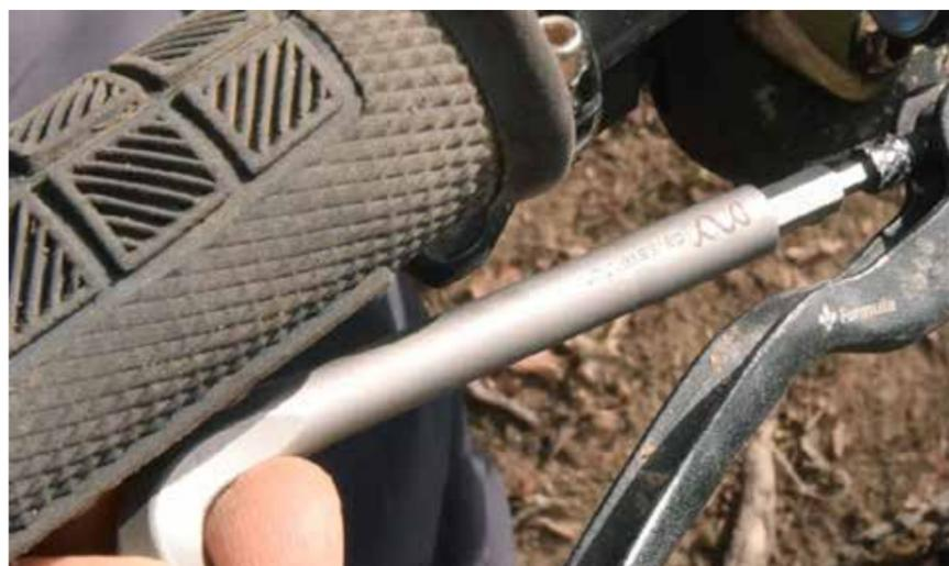
chaque côté et sont maintenues en place. Les retirer est aussi facile que de les installer. À l'autre extrémité, il y a la partie métallique qui s'installe sur la partie en composite du démonte pneu grâce à un rail. Cette partie dispose de 3 fonctions.
