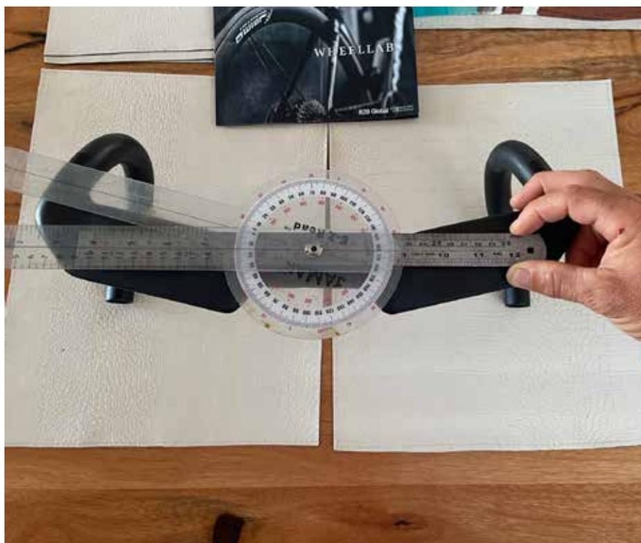
Ensuite, il y a le passage des câbles et gaines. Le V-Wing permet un passage semi-interne pour les vélos en frein à patins et interne pour les freins à disques. Le profil NACA du guidon est plat, ce qui est un plus aérodynamique mais aussi utile pour reposer ses avant-bras sur une surface plane plutôt que ronde. Plus la surface de contact est grande, plus il y a une répartition des forces. Personnellement, j'y ai collé une mousse amortissante de chaque côté pour optimiser le confort.
