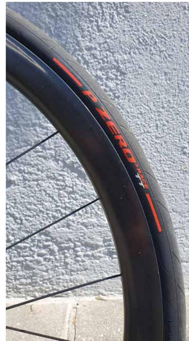
Le profil du pneu reste identique à la version standard, ce qui associé à la souplesse de la carcasse en fait un pneu proposant une excellente accroche. Dans la tendance actuelle, 2 tailles sont disponibles : 26 et 28 mm. En 26 mm, le pneu affiche 170 grammes sur la balance contre 190 grammes pour la version 28 mm. Et enfin, pour compléter cette rapide présentation, ce pneu "haut-de-gamme" vous coûtera 69,90 € dans votre boutique favorite.
